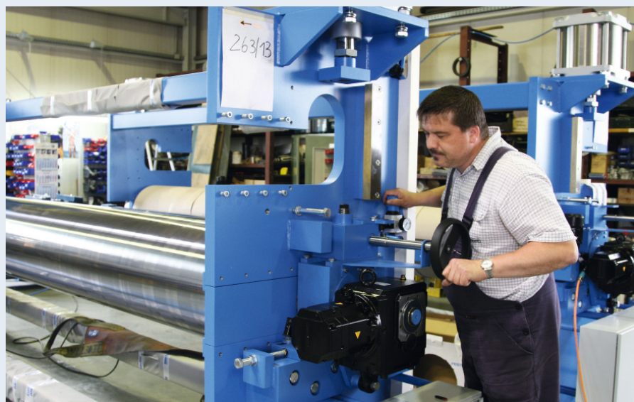
Maßgeschneidert nach Kundenwunsch: Automatisierungstechniker Rocco Weigert montiert eine von zwei Maschinen zur thermischen Glättung von Stoffen.
