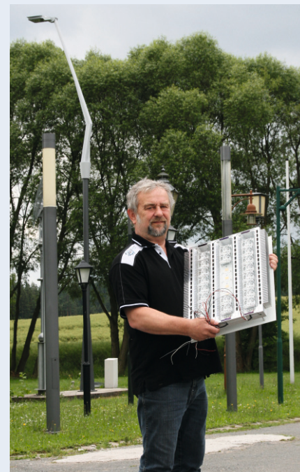
Jürgen Klaus: Nur mit dem von uns entwickelten Kühlsystem, das wie ein Kamin funktioniert, können die LED-Straßenleuchten auch im heißen Klima bestehen.
