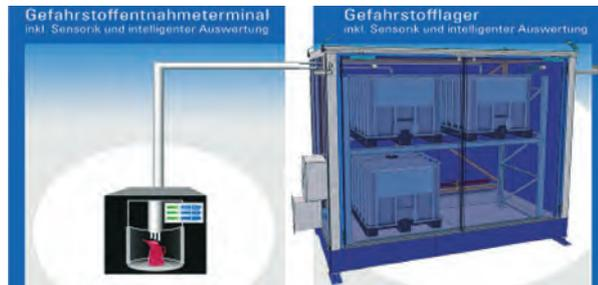
Intelligentes Gefahrstofflager mit angeschlossenem Gefahrstoffentnahmeterminal
