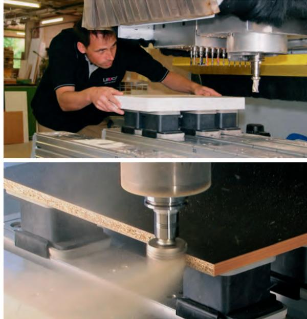
Einrichtung einer Holzbearbeitungsmaschine (oben) und Kantenbearbeitung (unten)
